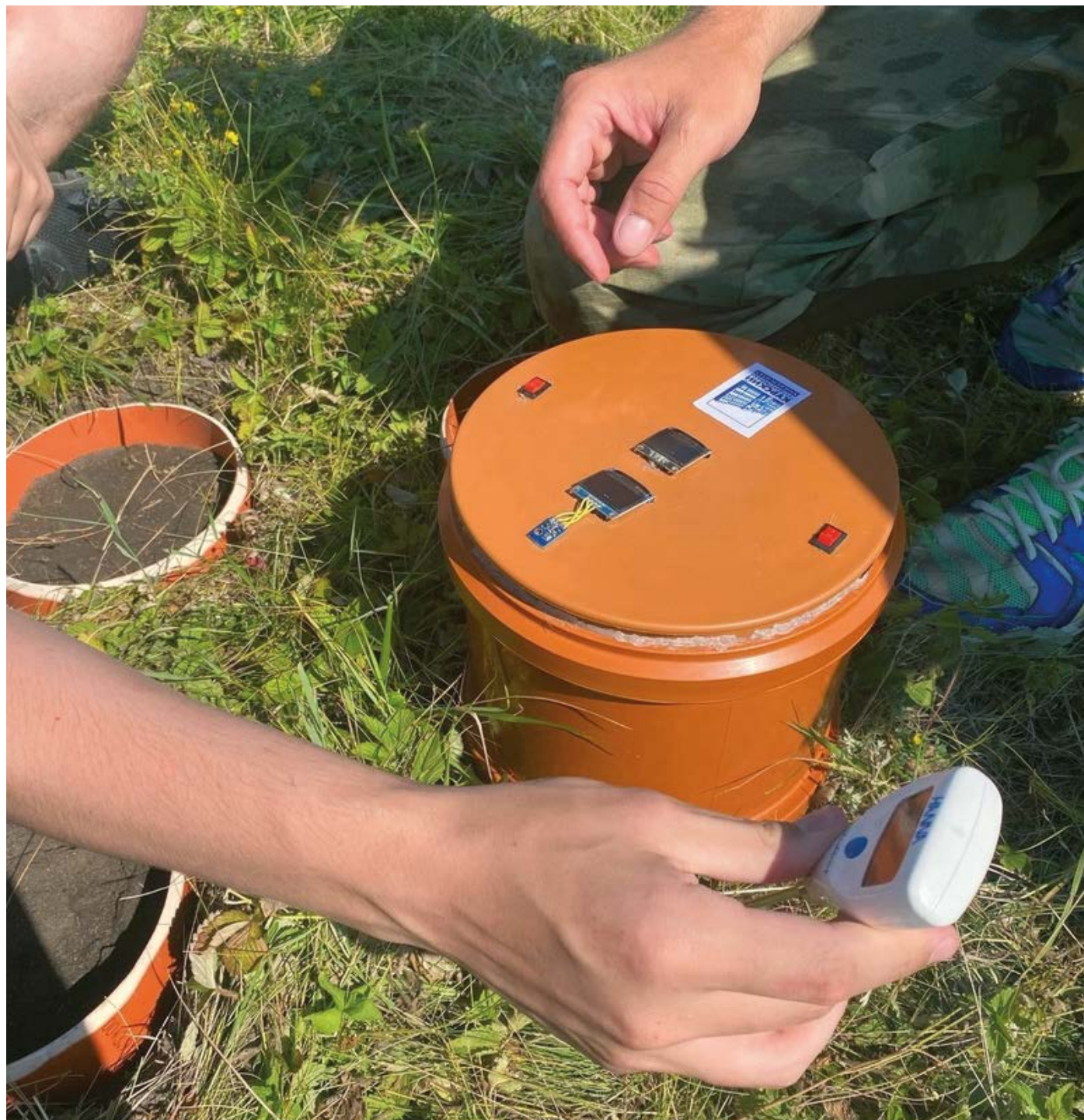
Рис. 15.78. Измерение скорости почвенных потоков \text{CO}_2 с поверхности аллювиальных почв поймы р. Сейм с использованием запатентованной учеными КГУ методики
